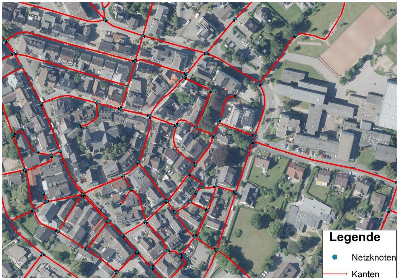
Abbildung 2: Erstellung eines Knoten-Kanten-Systems für Breckerfeld, Quelle: Ge-Komm GmbH
